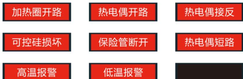
假如温控箱一开机即显示黑屏，请检查零线和火线是否接错，很多情况下，因为零线和火线接错或者松脱，导致输入电压从正常220V变成380V，温控器检测到380V输入电压，启动输入保护。
